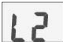
Retroiluminación Nivel 2 (parpadea)
